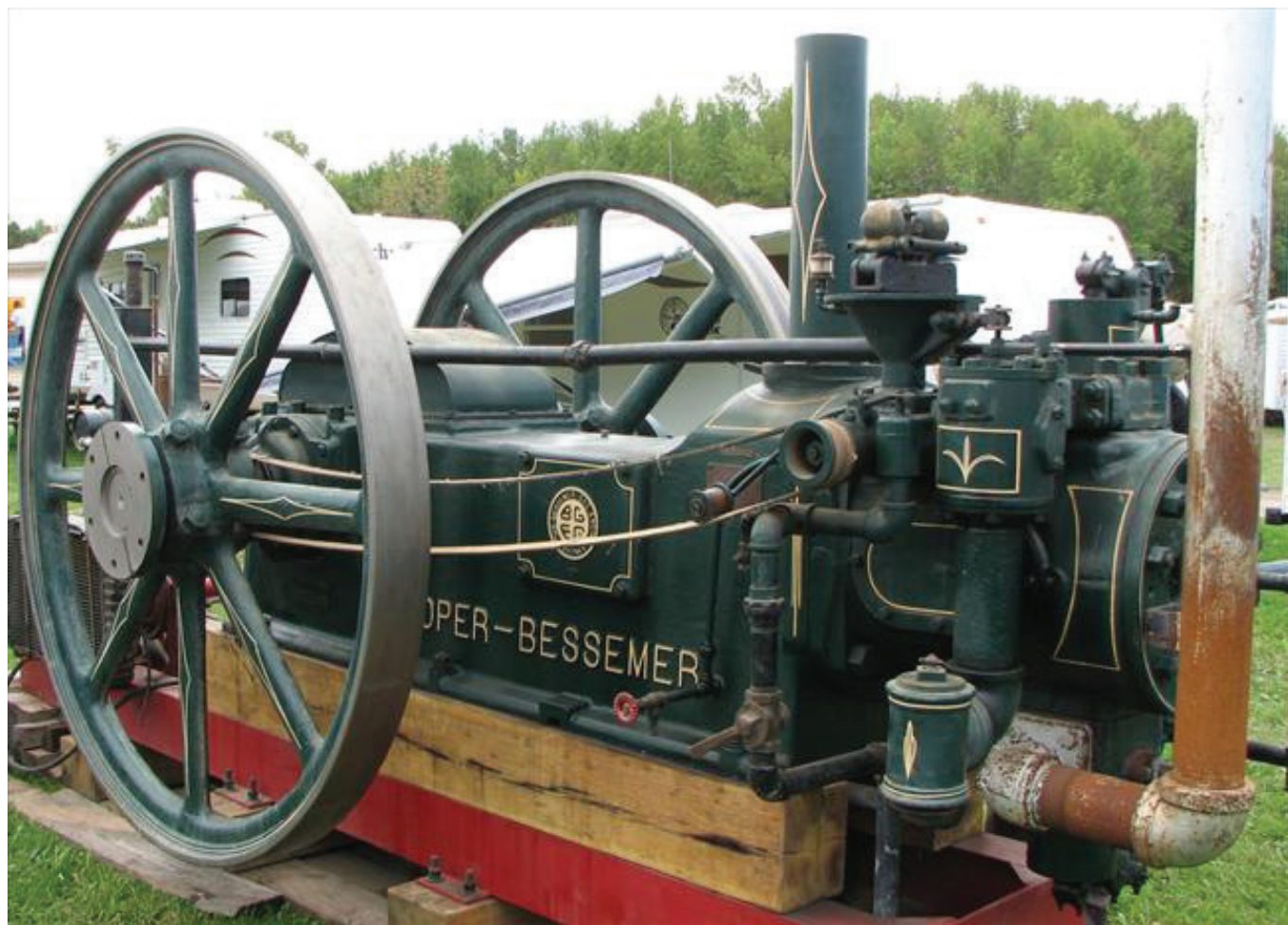
Четырехтактный одноцилиндровый горизонтальный газовый двигатель, выпускался заводом с 1930 г. по 1985 г.
